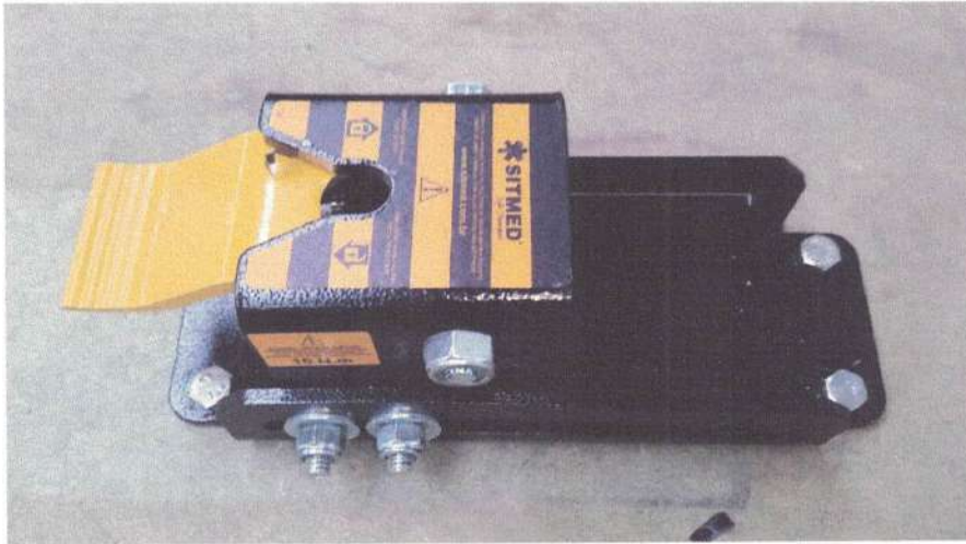
Foto 03 - Sistema de ancoragem traseiro
