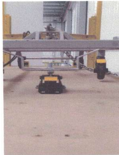
foto 04 - Pontos de fixação da maca
