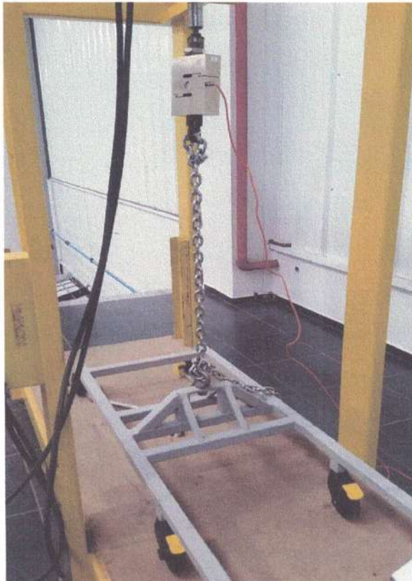
Foto 06 - Aplicação de carga no sentido vertical
