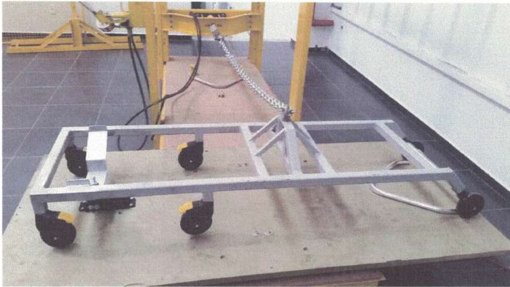
Foto 07-Aplicação de carga no sentido lateral
