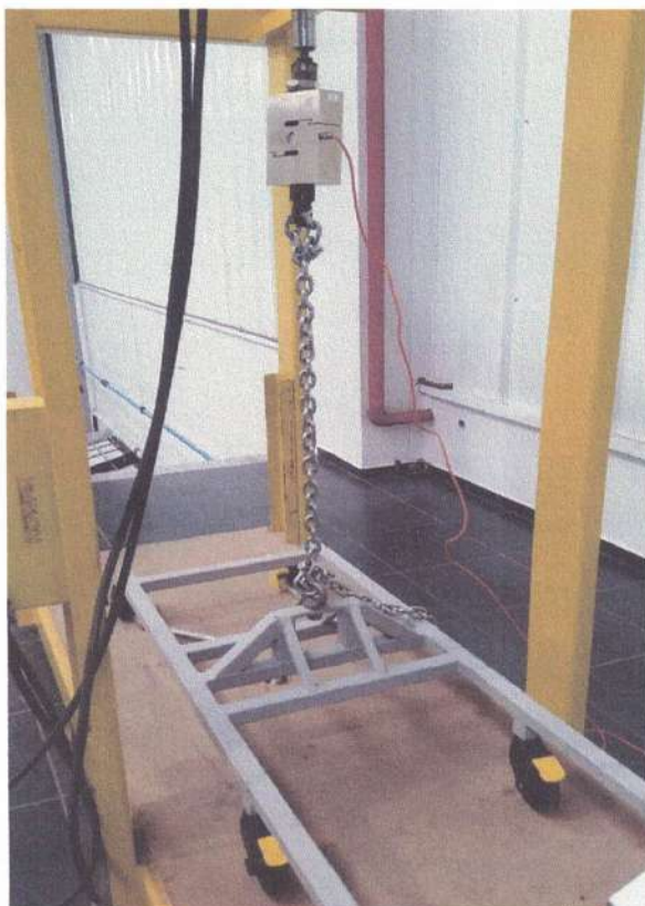
Foto 06 - Aplicação de carga no sentido vertical
