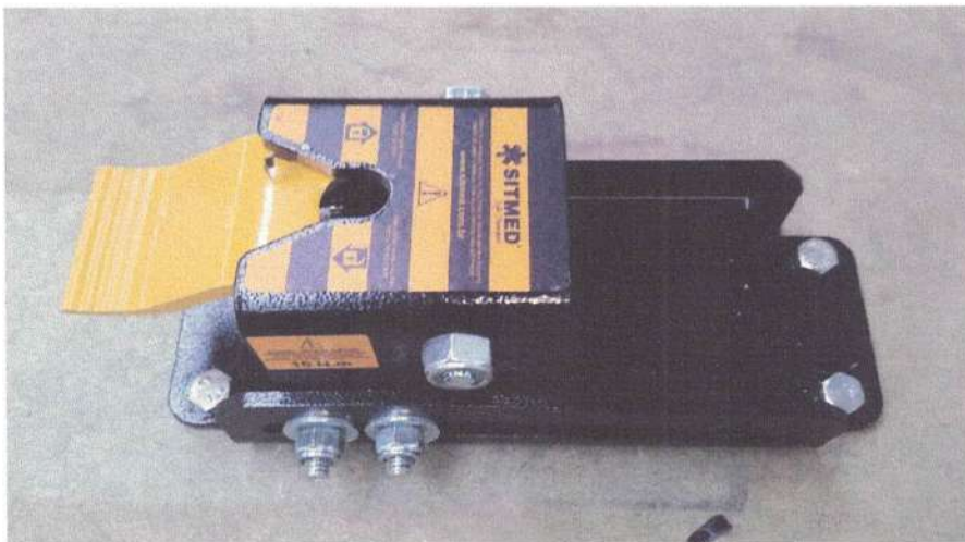
Foto 03 - Sistema de ancoragem traseiro
